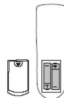
2. Строго соблюдая полярность, установите две батарейки размера AAA в отсек. При этом полярность можно определить по символам "+" и "-" как на батареях, так и внутри батарейного отсека пульта ДУ.
