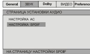
2.1) установить **тип выхода аудио** (SPDIF OFF – при выборе этого пункта аудио в аналоговой форме будет передаваться через L, R, LS, RS, Center и Subwoofer на задней панели плеера; SPDIF/RAW или SPDIF/PCM - при выборе одного из этих пунктов аудио будет передаваться в цифровой форме через оптический или коаксиальный выход на задней панели плеера на Dolby Digital / DTS декодер внешнего устройства)
