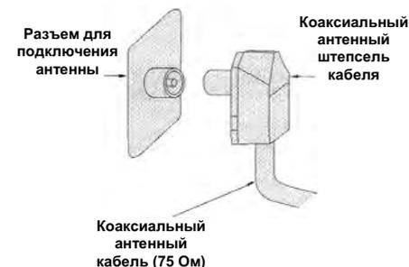
Рекомендуется аккуратно вставить коаксиальный антенный штепсель кабеля в разъем для подключения антенны на задней панели телевизора.
